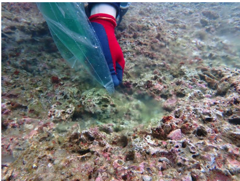
ポリマー溶液を海底面に散布
